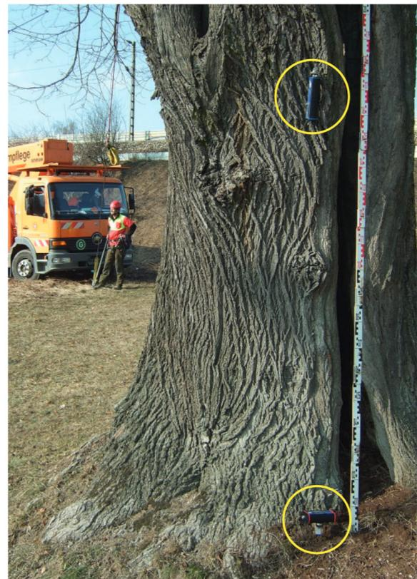
Abbildung 3: Aufbau eines Zugversuchs an einem Naturdenkmal
