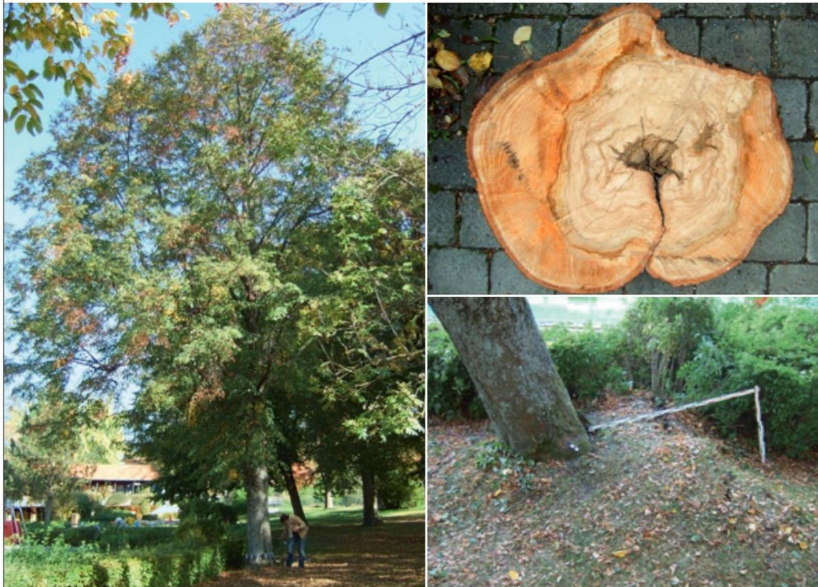
Abbildung 6: Kippverlauf für eine Linde mit Brandkrustenpilzbefall (Auszug)
